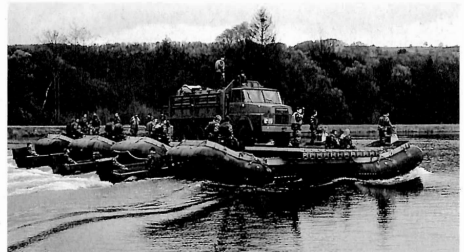
Ponton-Fähre der Genietruppen beim Flachsee-Einsatz (Belagserneuerung von Kies-Inseln, Foto Herbst 1990).
